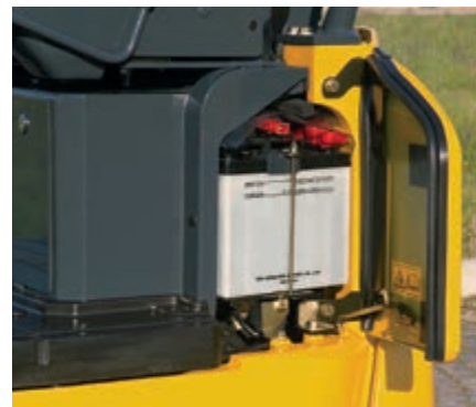
Linker kap: gemakkelijke toegang tot de accu
