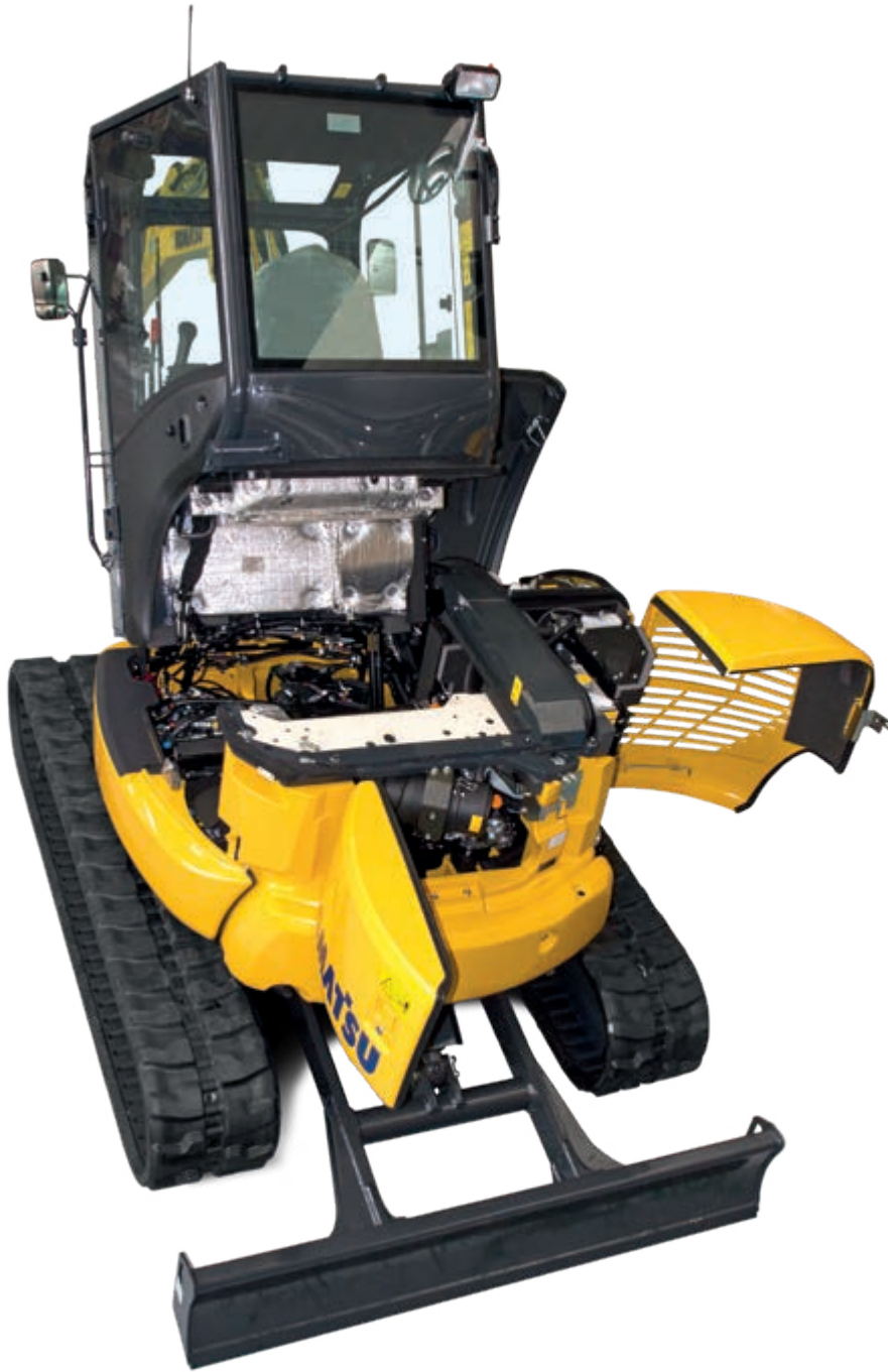
Achterkleppen voor een snelle motorcontrole, gemakkelijke controle en reiniging van de radiateurs en een snelle toegang tot de accu
